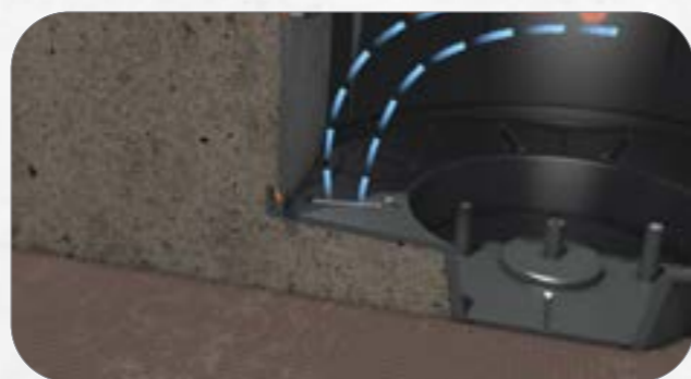
8. Durch Lüftungsschlitze keine Lufteinschlüsse und Nesterbildung. XL-Serie ist dadurch ideal für Sichtbeton geeignet.
