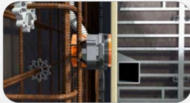
2. Flexible Flügel passen sich der jeweiligen Betondeckung an. Betondeckungen zwischen 20–40 mm oder 40–60 mm. Nach dem Stellen der Gegenschalung kann betoniert werden.
