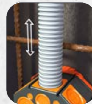
3. Kabel oder (starre) Rohre M20, M25 und M32 einführen. Membrantechnik ermöglicht eine absolut betondichte Einführung (l). Sichere Zugentlastung durch Rohrgrip – kein Kürzen der Rohre erforderlich (r).
