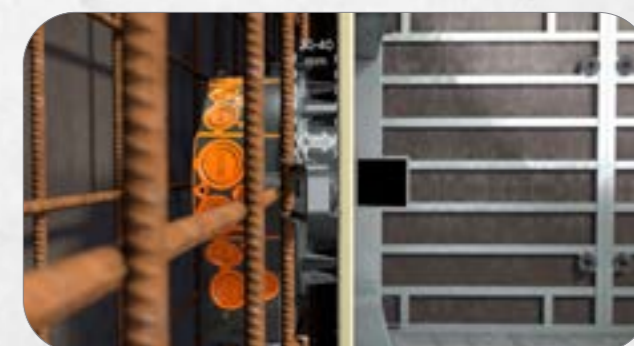
4. Flexible Flügel passen sich der jeweiligen Betondeckung an. Betondeckungen zwischen 20 – 40 mm oder 40 – 60 mm sind möglich. Nach dem Stellen der Gegenschalung kann betoniert werden.
