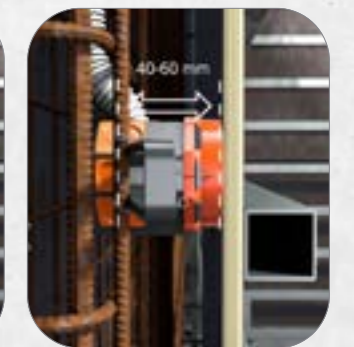
4. Flexible Flügel passen sich der jeweiligen Betondeckung von 20 – 40 mm oder 40 – 60 mm an.
